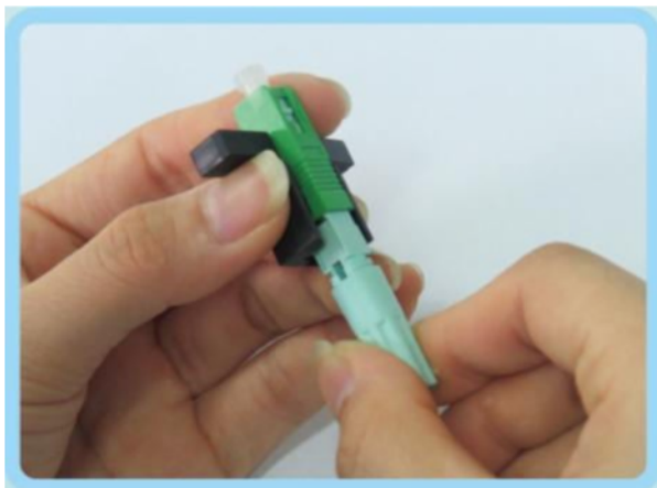
Desrosqueie a tampa de fixação do cabo drop
