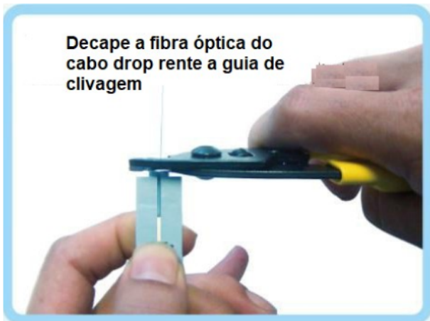
Encaixe o cabo na Guia de Clivagem e decape a fibra
